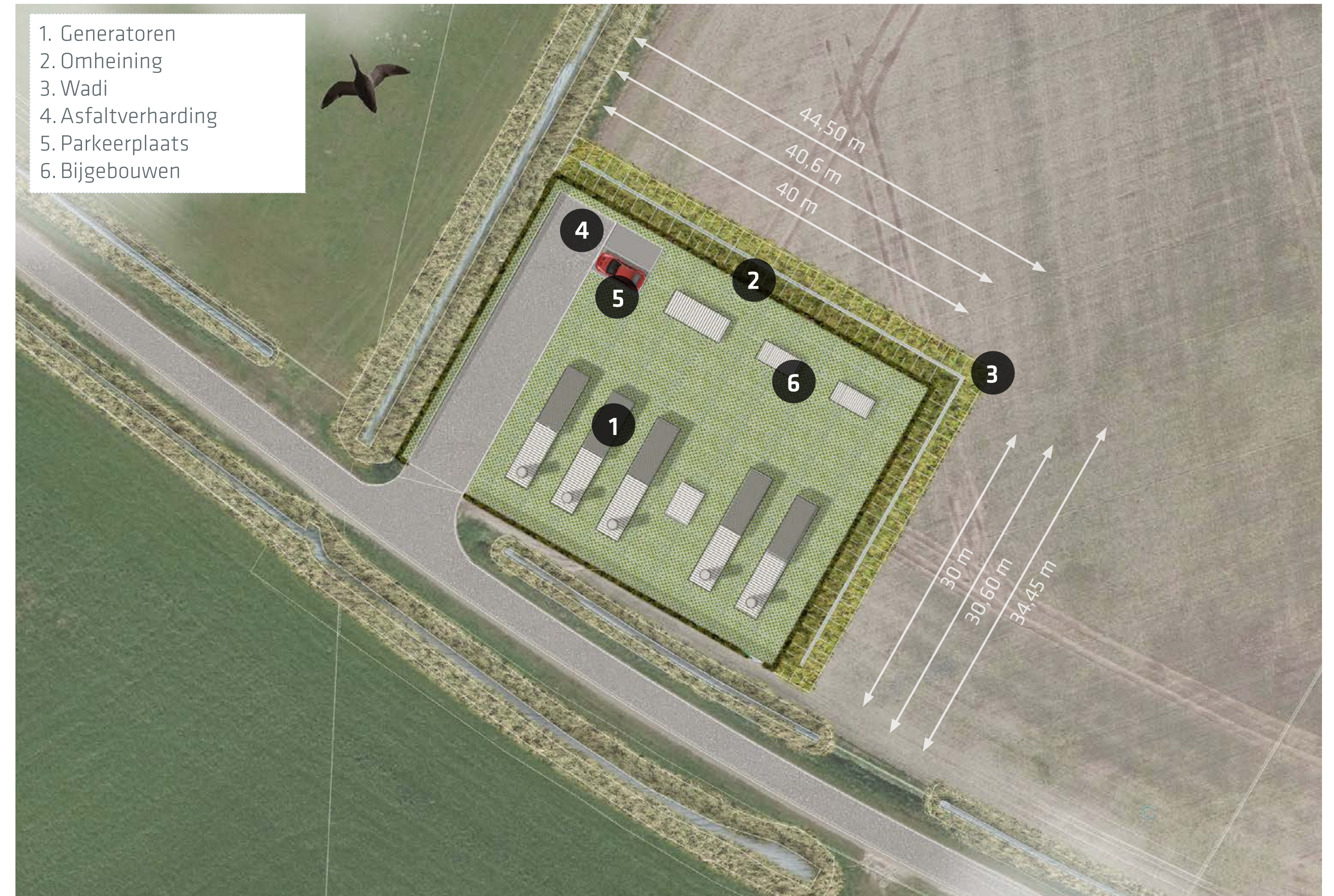
Figuur 2. Conceptuele visualisatie van een opstelling van stroomgeneratoren in een fictief landschap (totaal vermogen 10 MW)
