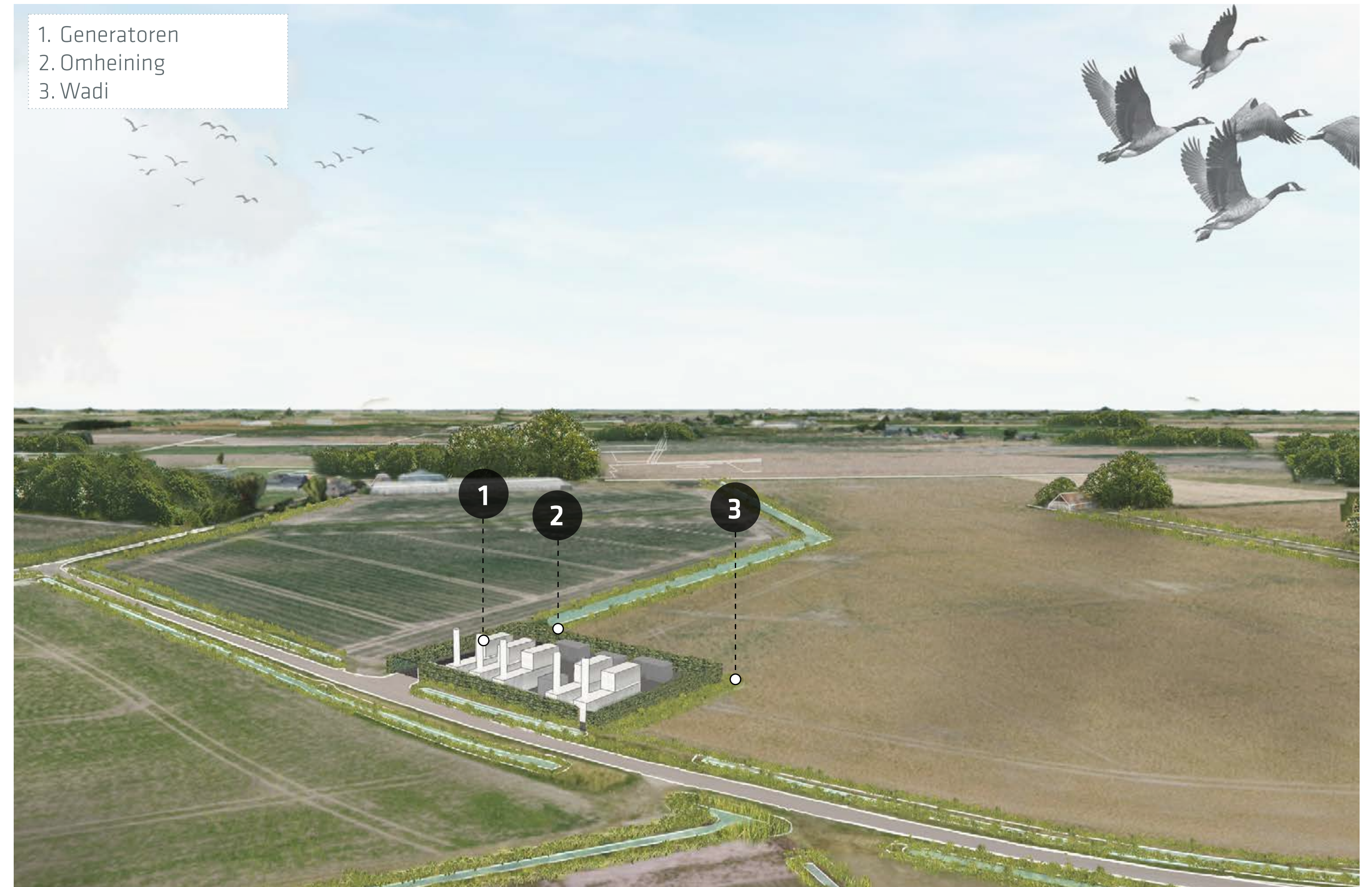
Figuur 1. Conceptuele visualisatie van een opstelling van stroomgeneratoren in een fictief landschap (totaal vermogen 10 MW)
